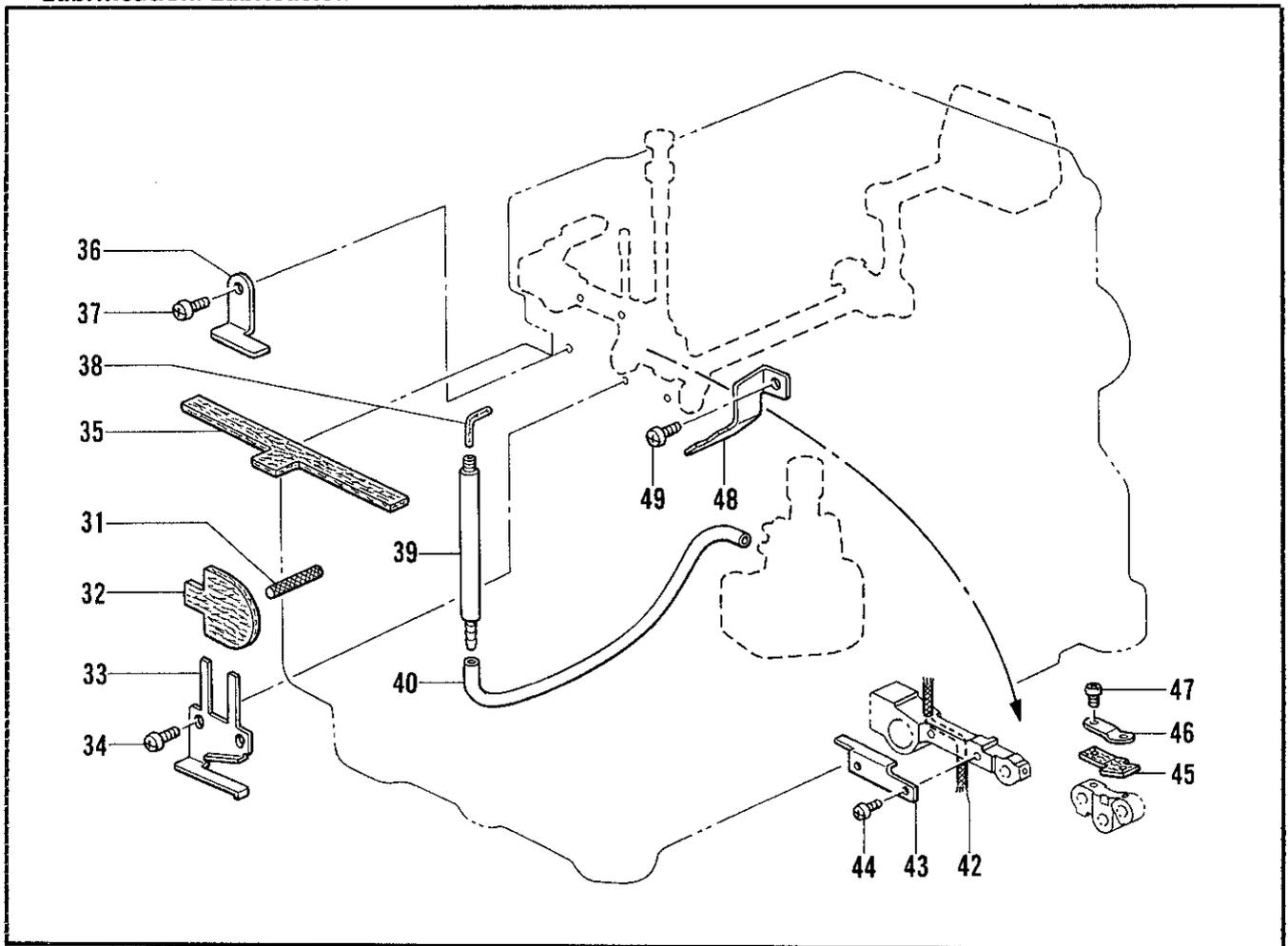
M. 針冷却装置/Needle cooler/Nadelkühlungsvorrichtung/
