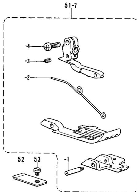
D. 押工関係/Presser foot mechanism/Stoffdrückerfuß/
