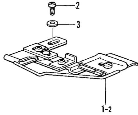
S. ラッパ-関係/Lapper mechanism/Falz-Mechanismus/
