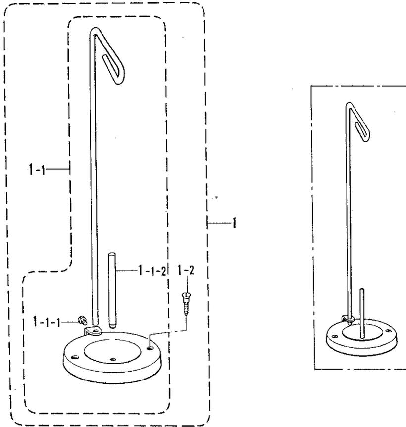
Q. テープワインダー関係 / Tape winder mechanism / Bandaufwickelvorrichtung /
