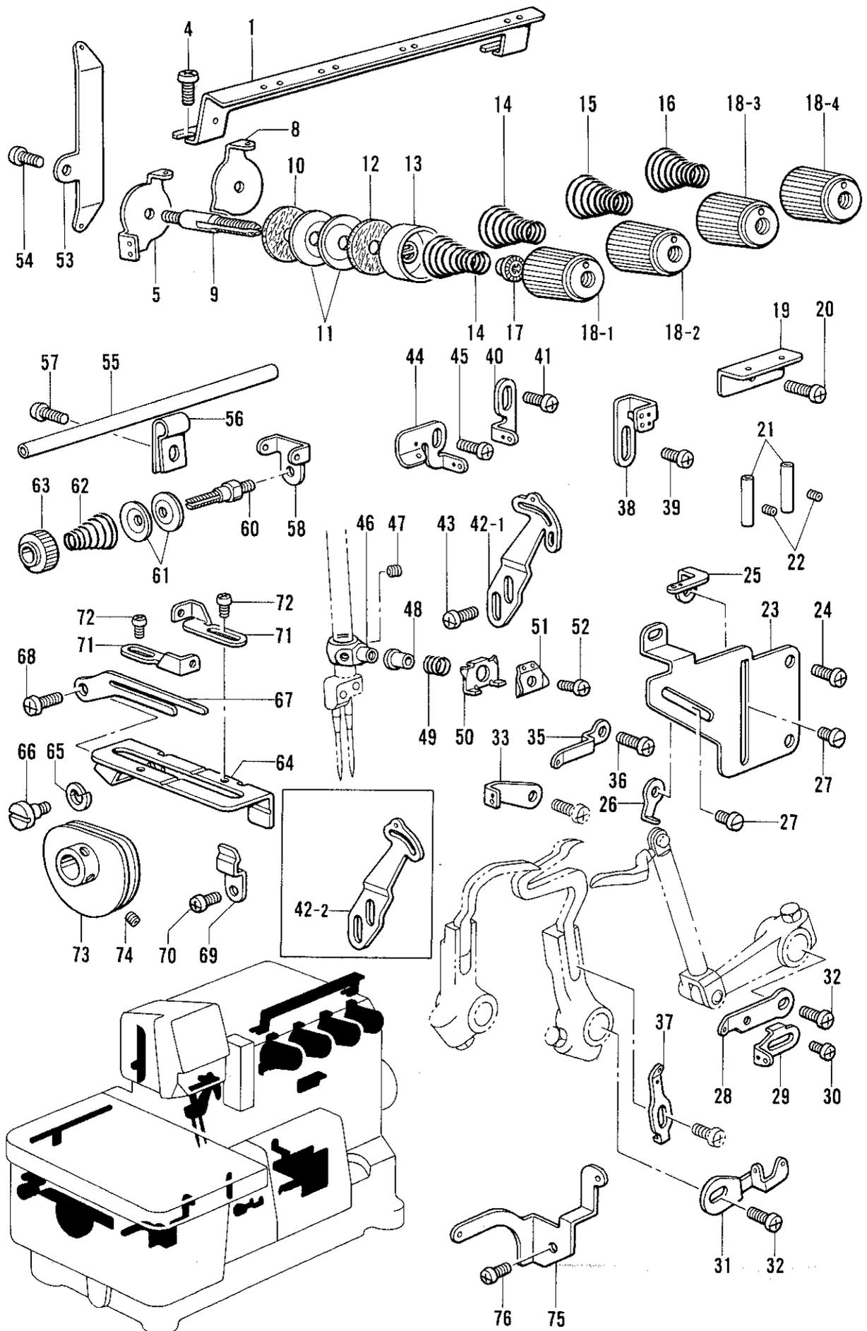
N. 糸調子関係/Thread tension/Faderspannung/
