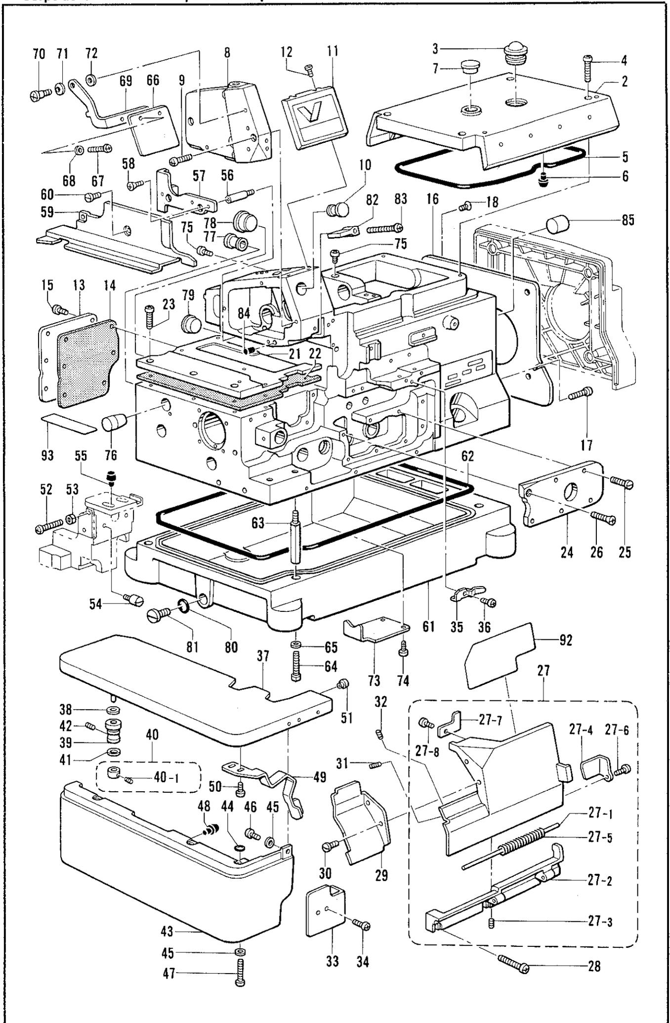
A. フレーム関係/Machine body/Maschinengehäuse/
