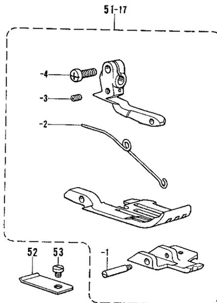
D. 押工関係/Presser foot mechanism/Stoffdrückerfuß/
