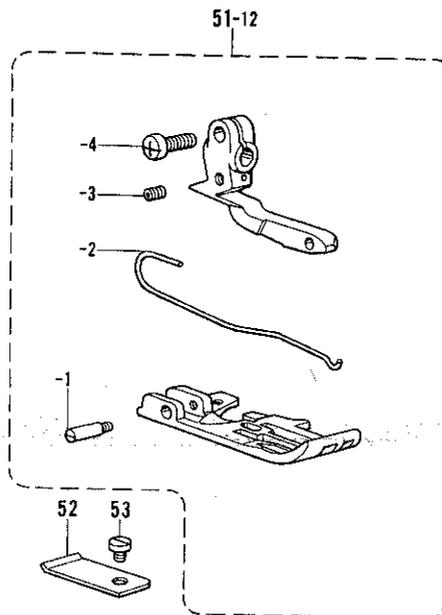
D. 押工関係/Presser foot mechanism/Stoffdrückerfuß/
