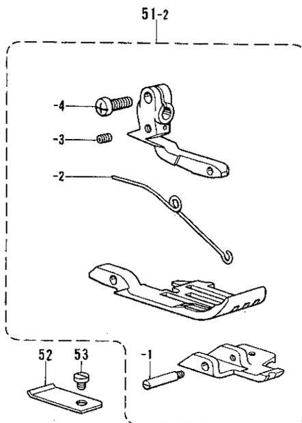
D. 押工関係/Presser foot mechanism/Stoffdrückerfuß/
