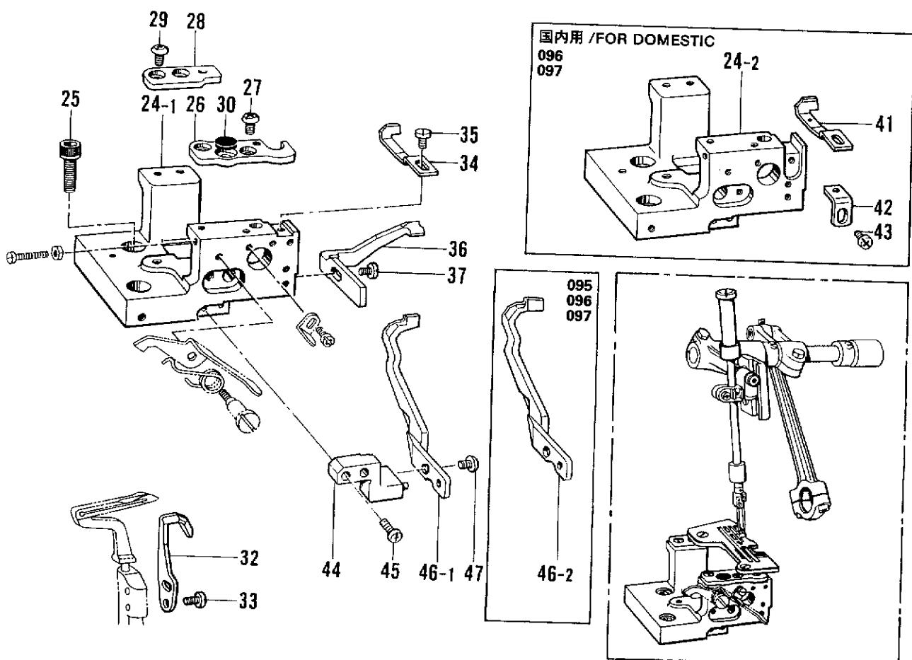
D. 針棒関係 / Needle bar mechanism / Nadelstangenvorrichtung /
