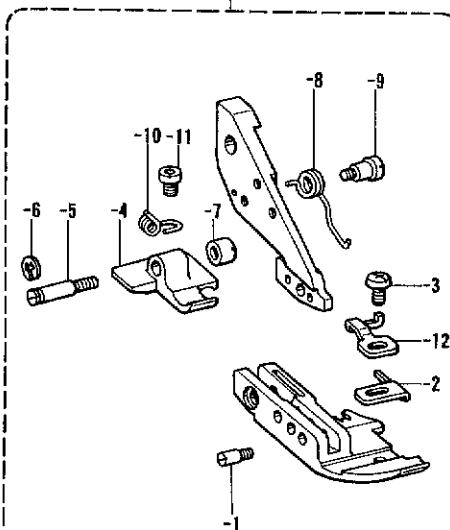
**E. 押工関係/Presser foot mechanism/Stoffdrückerfuß/
