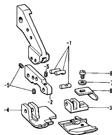
**E. 押工関係/Presser foot mechanism/Stoffdrückerfuß/
