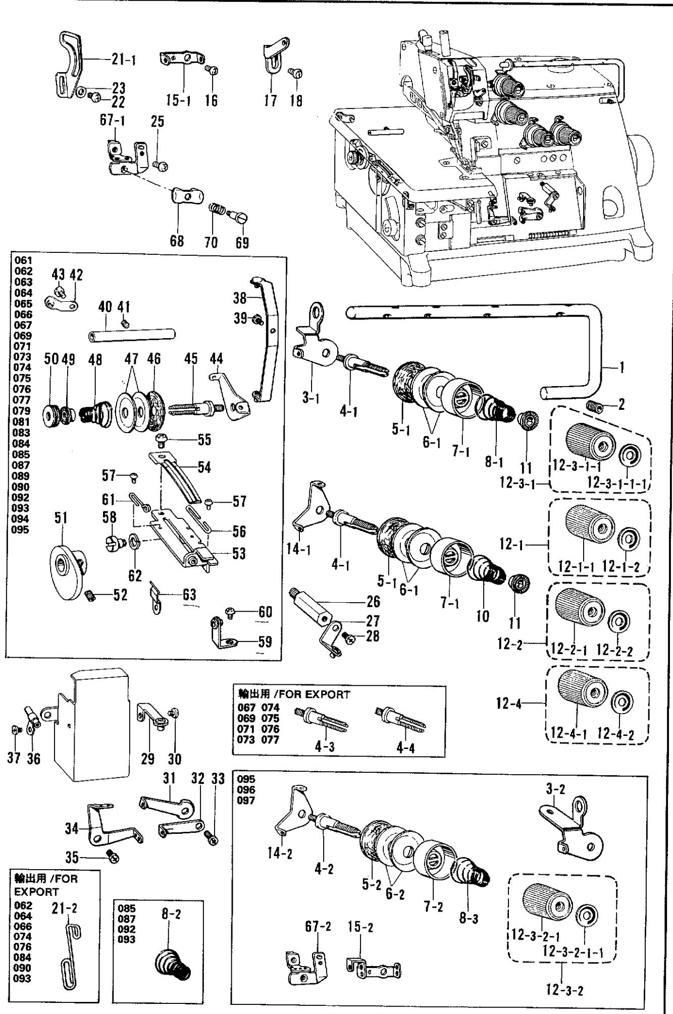
R. 糸調子関係 / Thread tension / Faderspannung / Tension du fil / Tension del hilo
