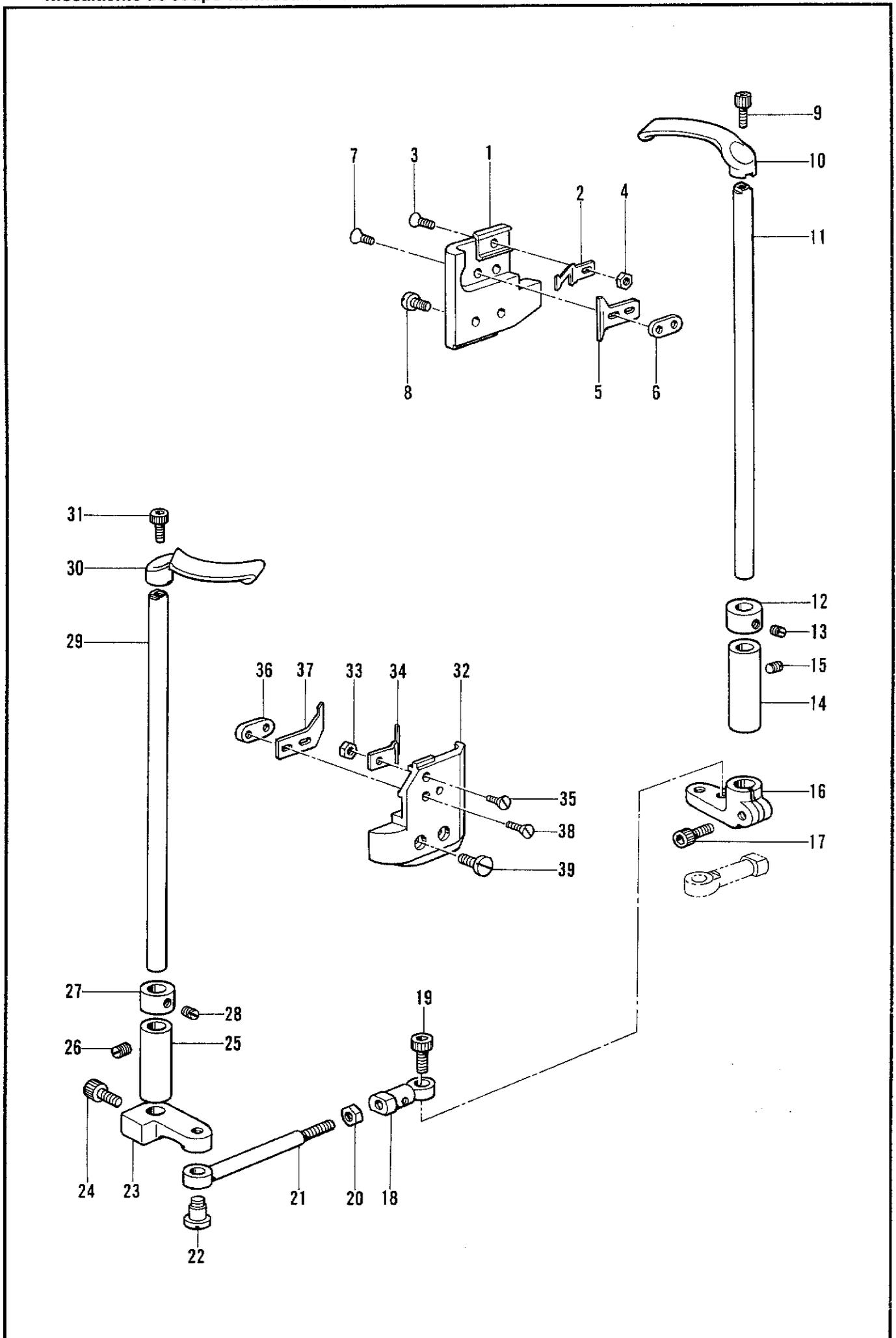
M1. 糸切り関係/Thread trimmer mechanism/Fadenabschneidevorrichtung/
