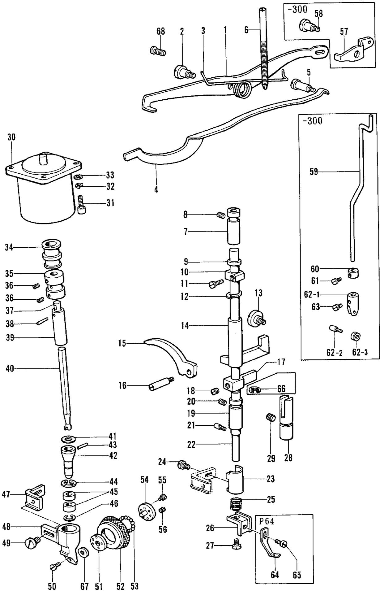
D. 押工関係/Presser foot mechanism/Stoffdrückerfuß/
