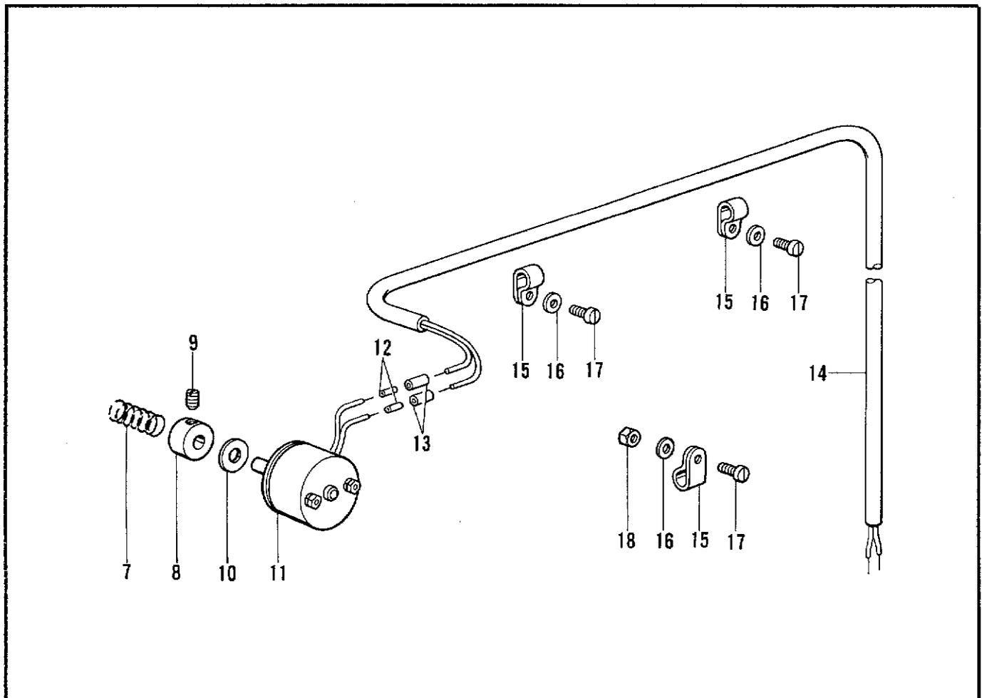
L1. 糸調子関係 / Thread tension / Faderspannung /
