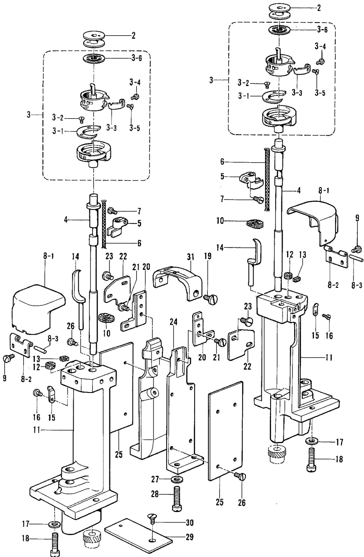
J2. カマ関係/Rotary hook mechanism/Greifervorrichtung/
