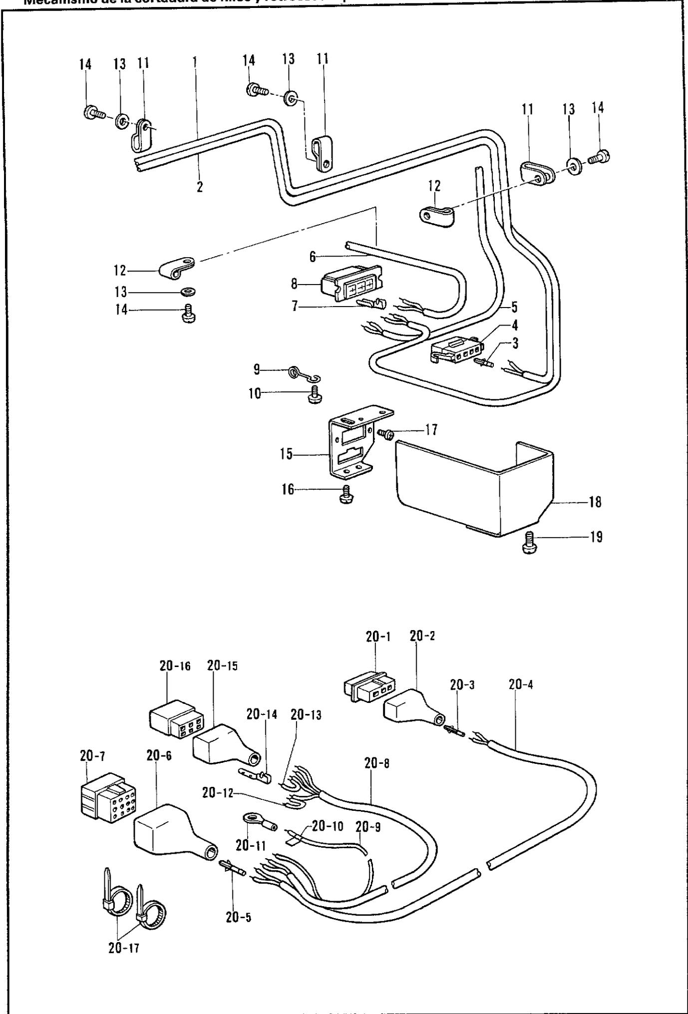
N. 糸切り・タッチバック関係 / Thread trimmer and quick back mechanism / Fadenabschneider und Schnellumkehrvorrichtung / Mécanisme de coupe-fil et retour arrière rapide / Mecanismo de la cortadura de hilos y retroceso rápido
