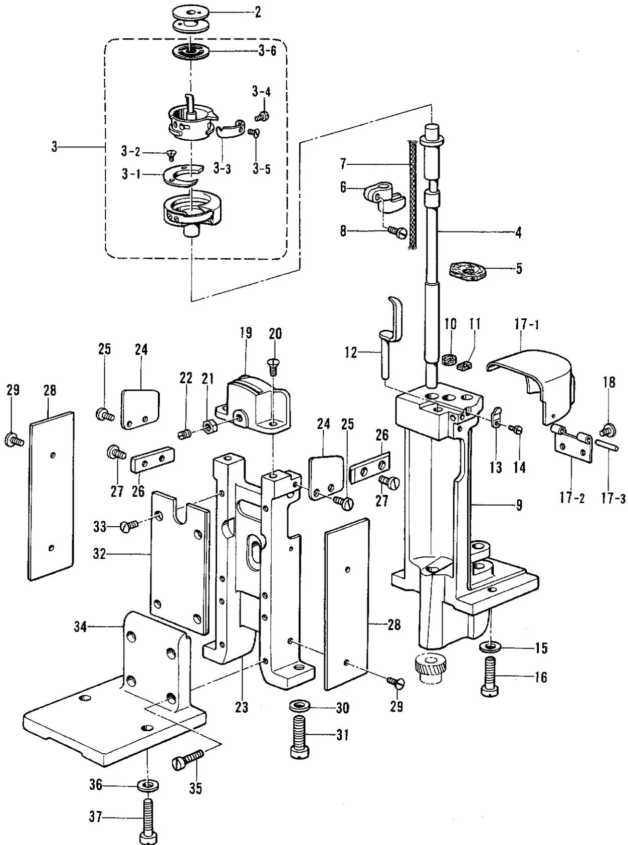
J1. カマ関係/Rotary hook mechanism/Greifervorrichtung/
