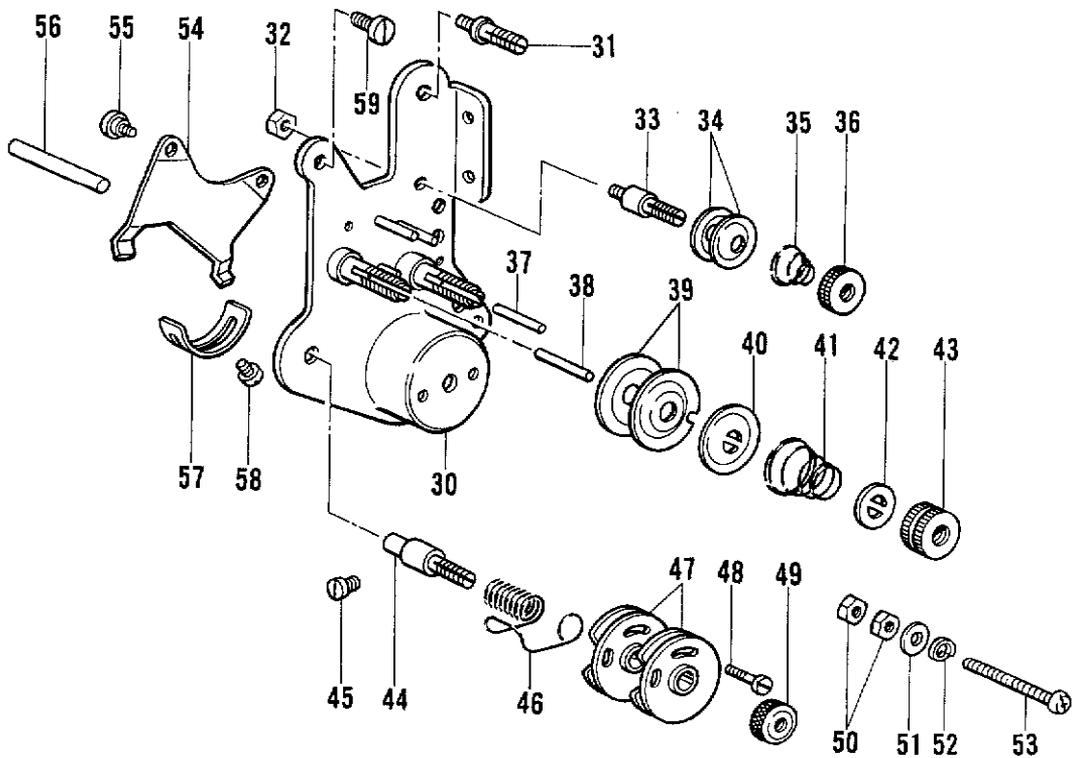
L3. 糸調子関係/Thread tension/Faderspannung/
