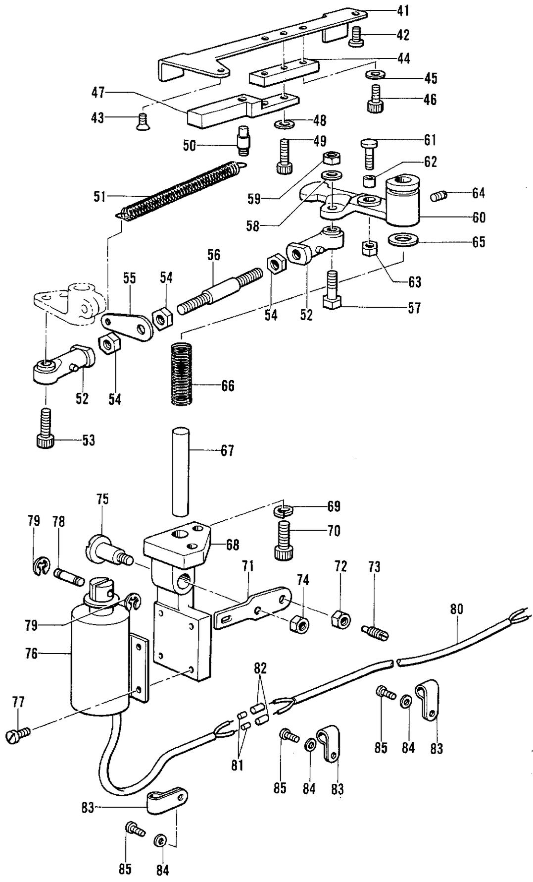
M2. 糸切り関係 / Thread trimmer mechanism / Fadenabschneidevorrichtung /
