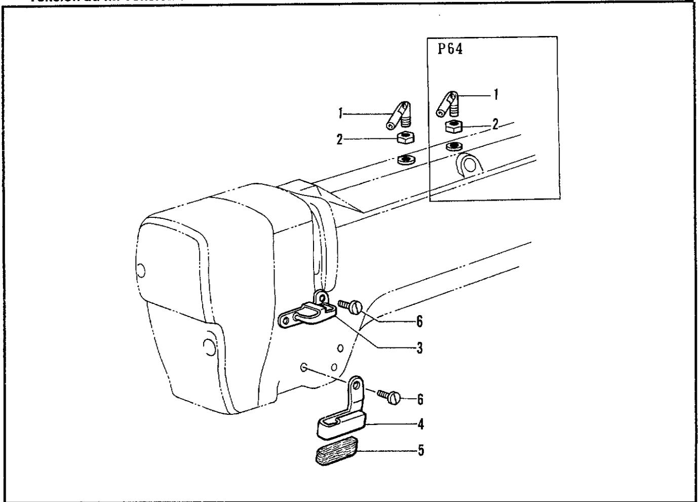
L2. 糸調子関係 / Thread tension / Faderspannung /
