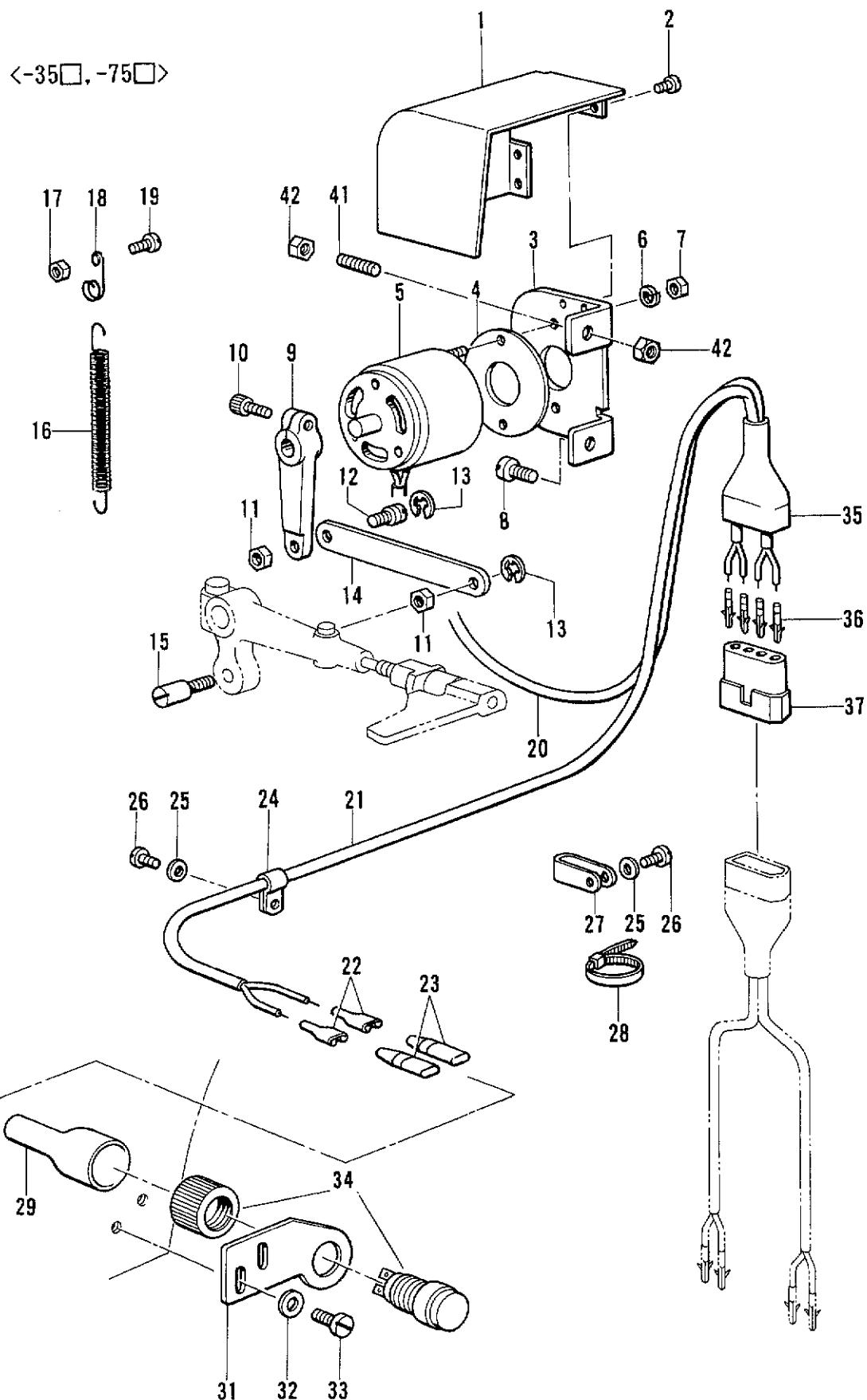
M. タッチバック関係 /Quick back/Schnellumkehrvorrichtung/
