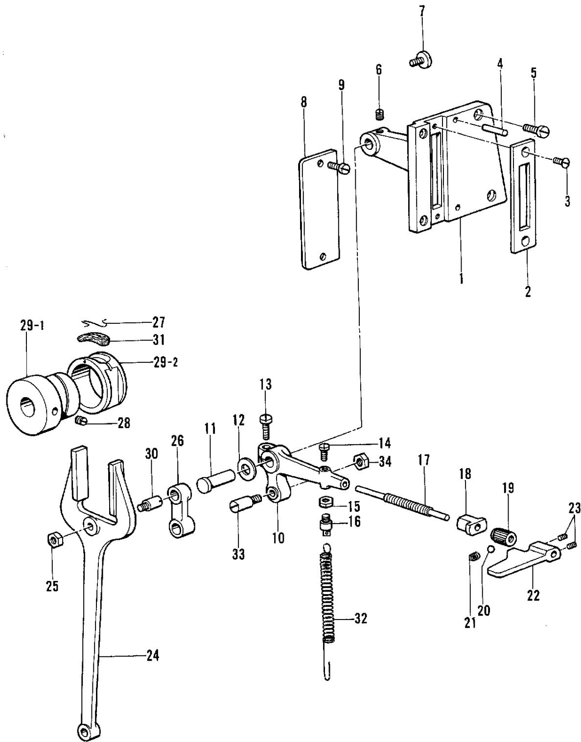
J. バック関係 /Reverse stitching mechanism/Rückwärtsnähvorrichtung/
