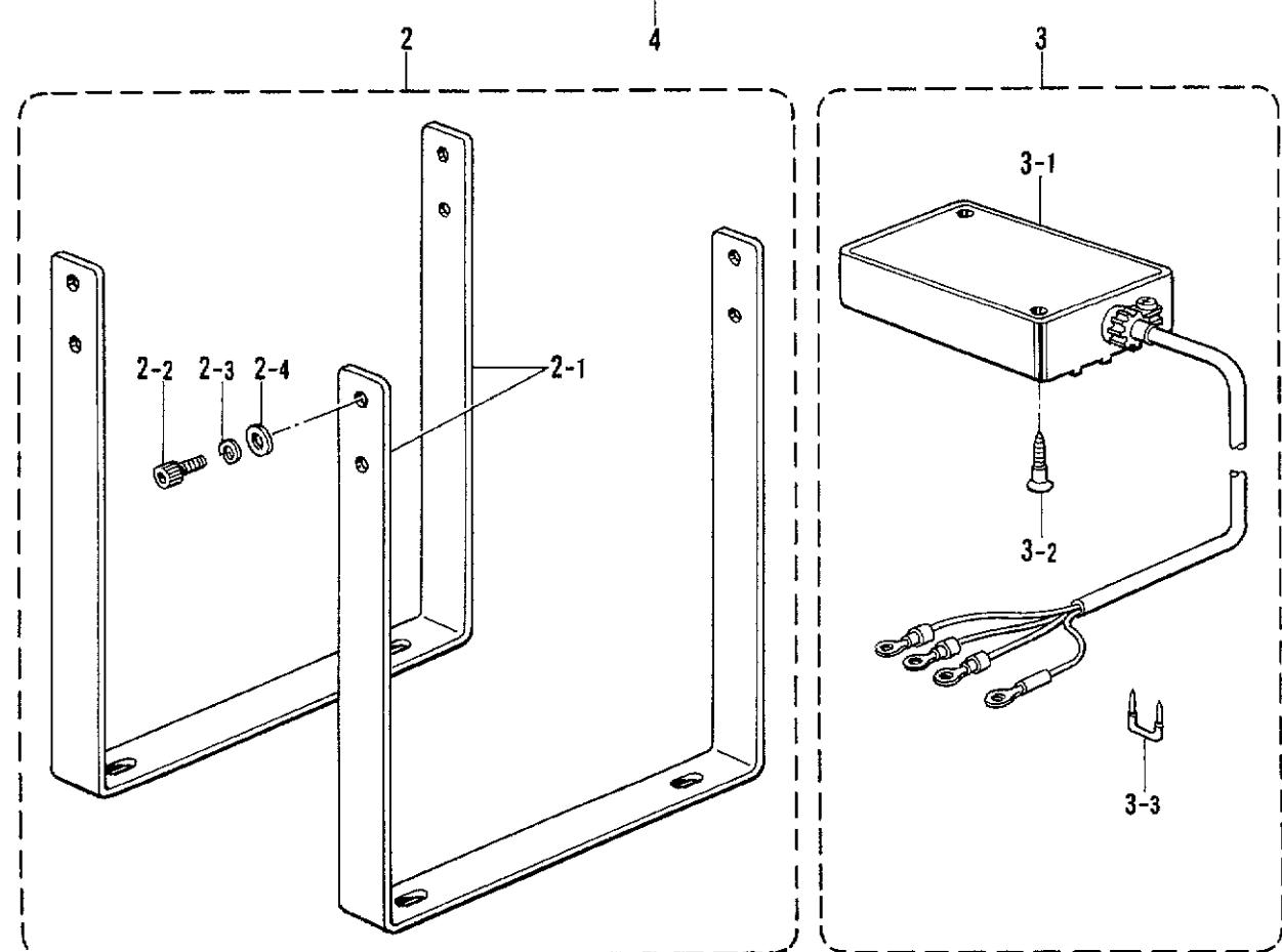
P3. パルスモータ式上ゴム送り関係 / Pulse motor drive top metering mechanism/
