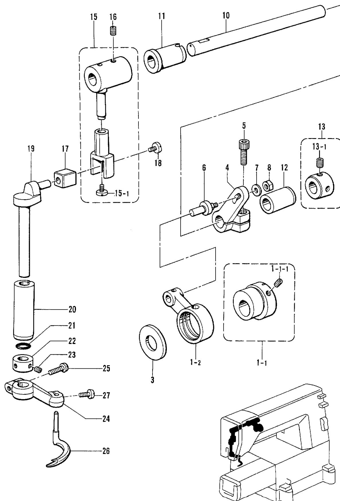
J. スプレーダー関係/Spreader mechanism/Spreizvorrichtung
