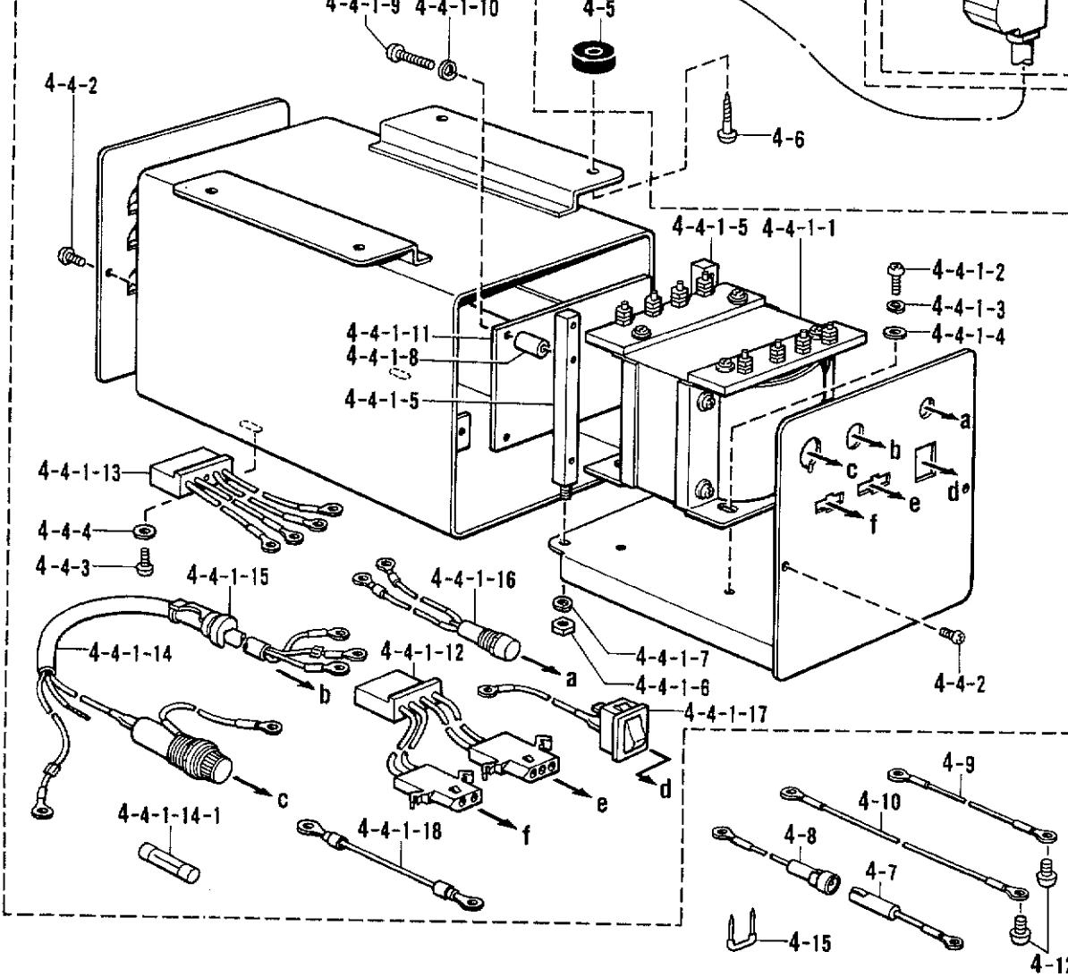
Q5. テープカッター装置関係 / Tape cutter mechanism / Bandabschneidesolenoid /
