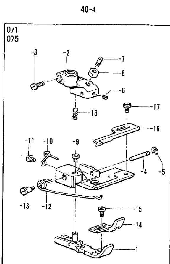
C2. 押工関係 / Presser foot mechanism / Stoffdrückerfuß /
