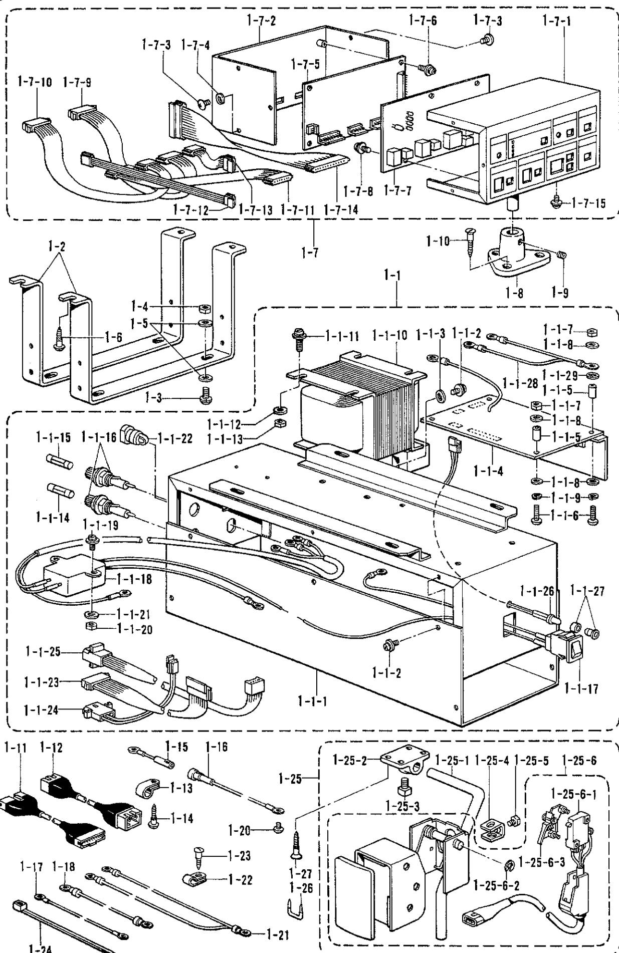
P2. パルスモータ式上ゴム送り関係 / Pulse motor drive top metering mechanism /
