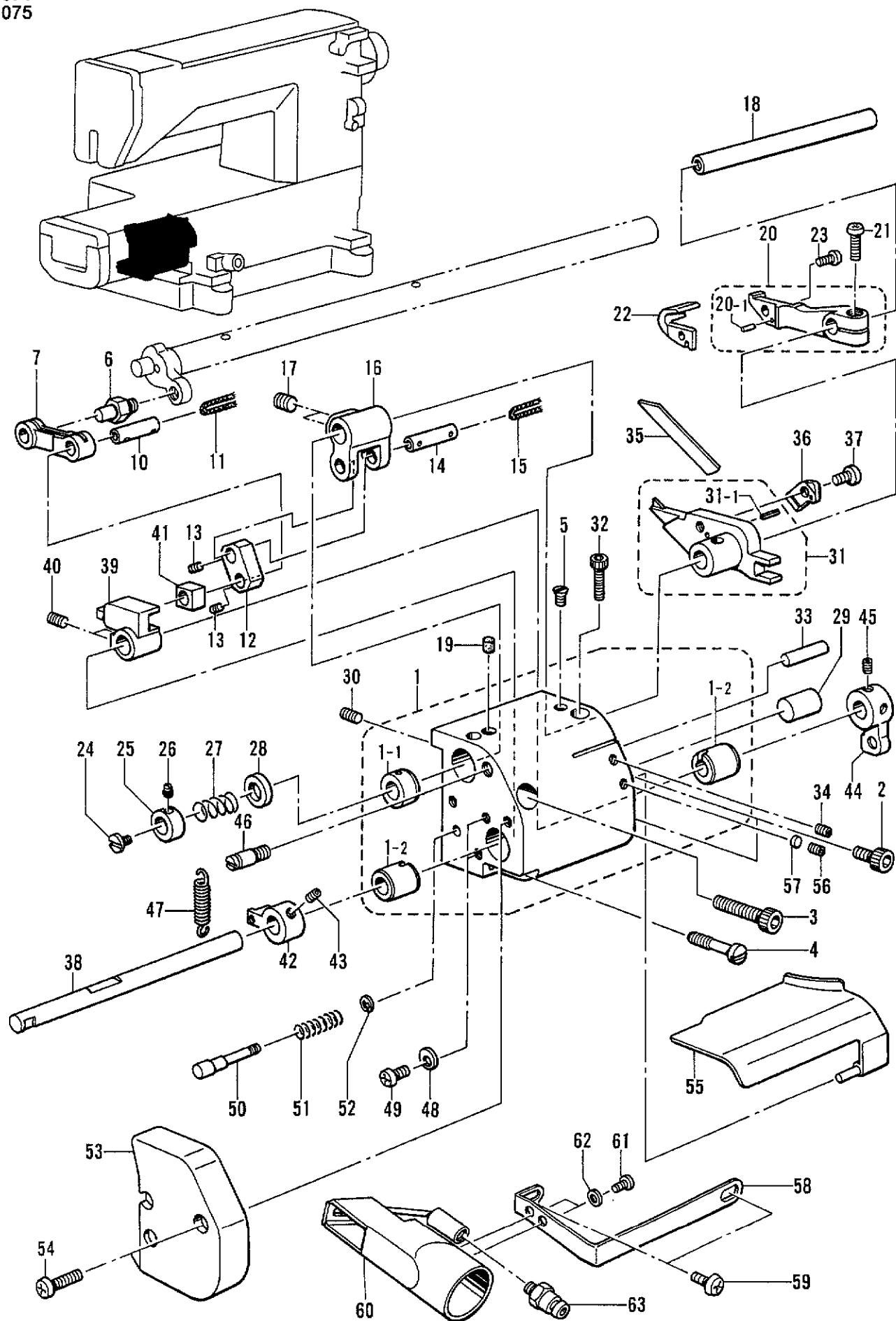
M1. トリミングメス関係 /Trimming knife mechanism/Fadenabschneidemessereinheit
