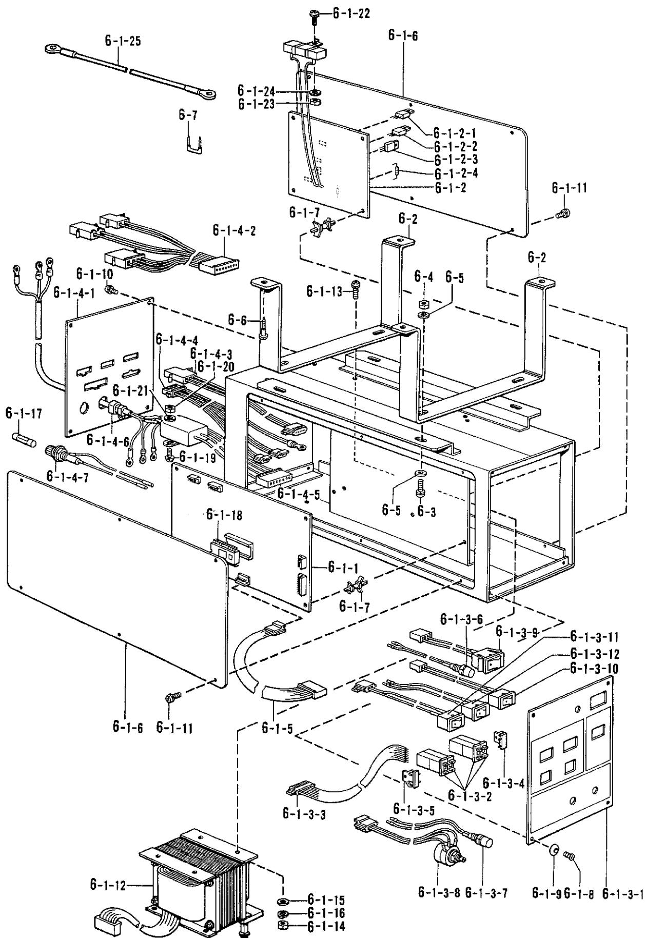
Q6. テープカッター装置関係 / Tape cutter mechanism / Bandabschneidesolenoid /
