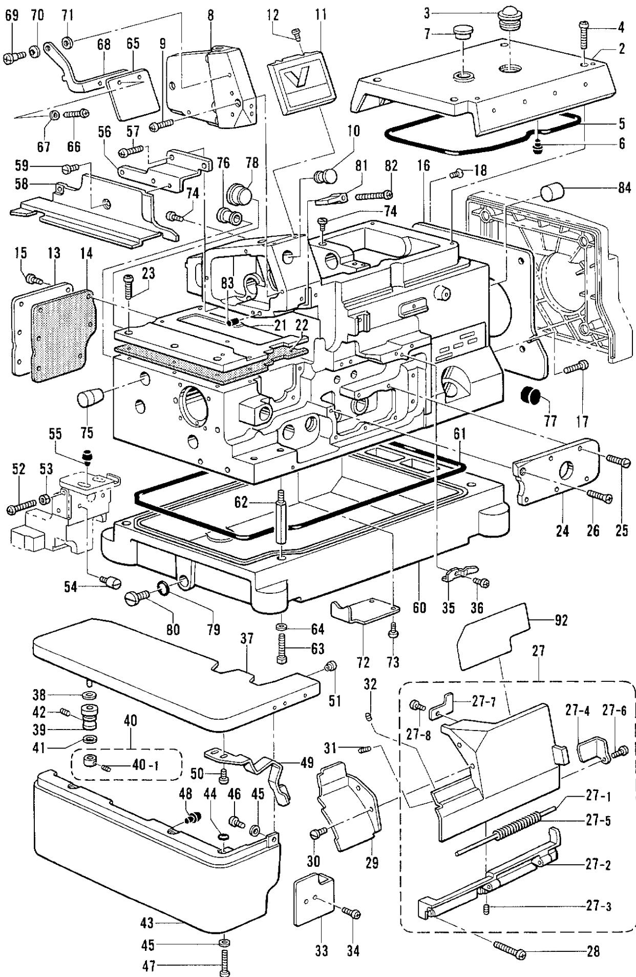
A. フレーム関係 /Machine body/Maschinengehäuse/
