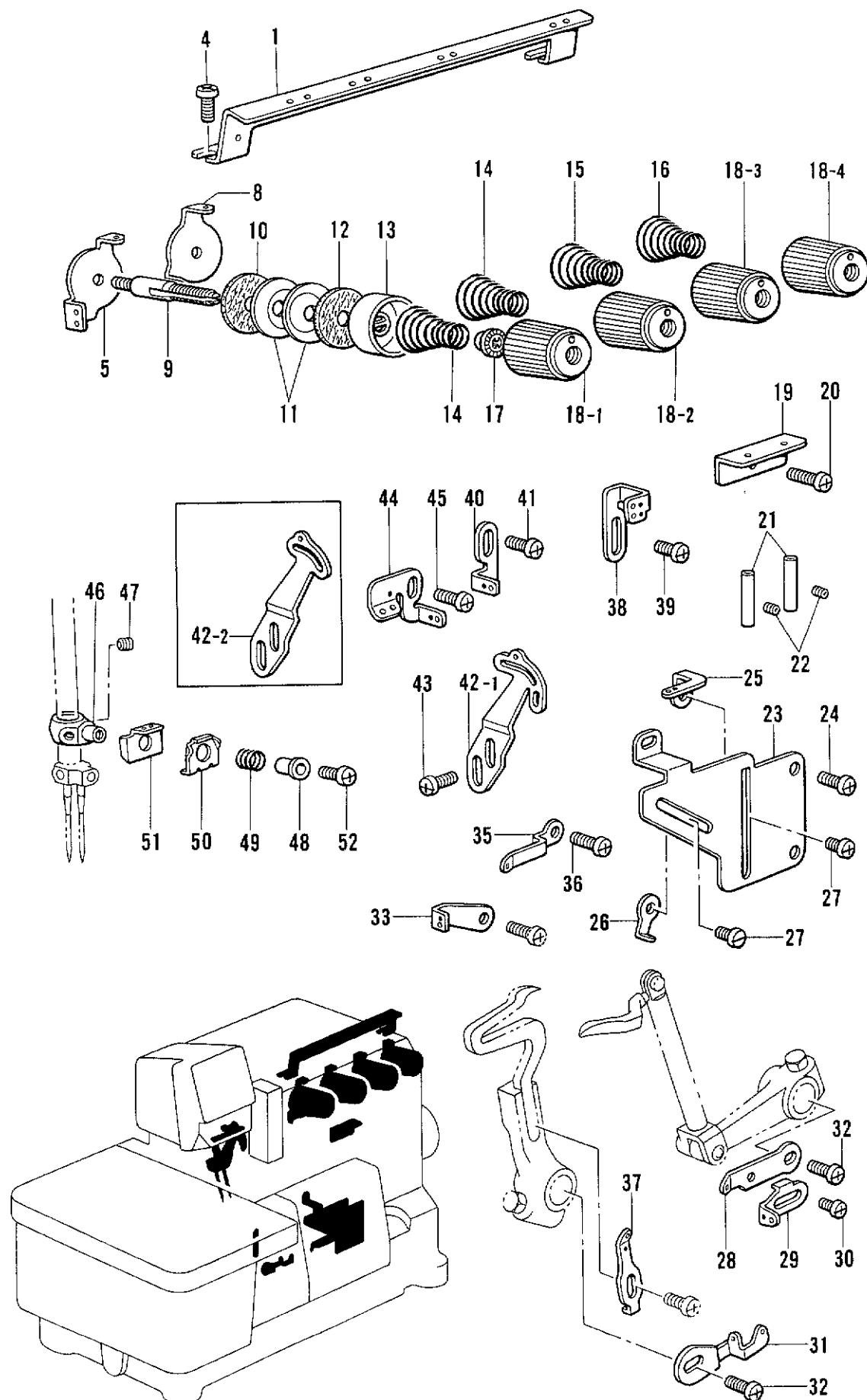
K. 糸調子関係 / Thread tension/Faderspannung/
