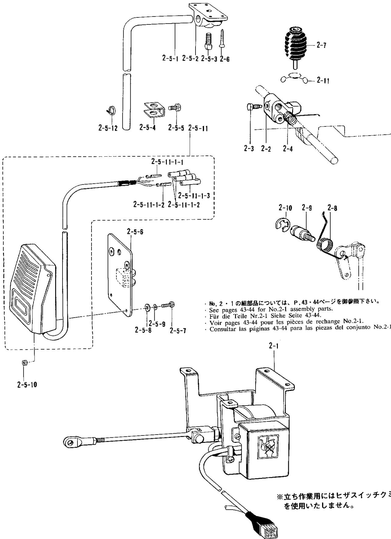
**W2. 電磁押工上部関係 / Presser foot lifting solenoid set / Solenoidsatz für die Anhebung des Stoffdrückerfußes /
