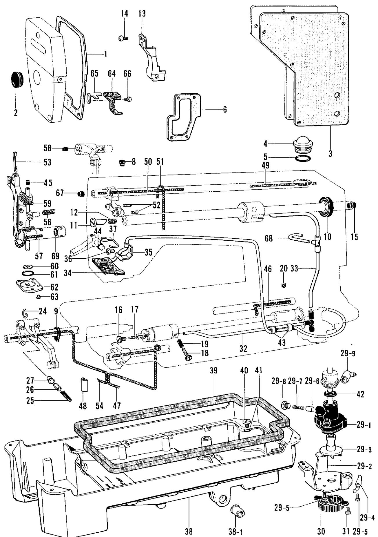
K. 給油潤滑関係 / Lubrication / Schmierung /
