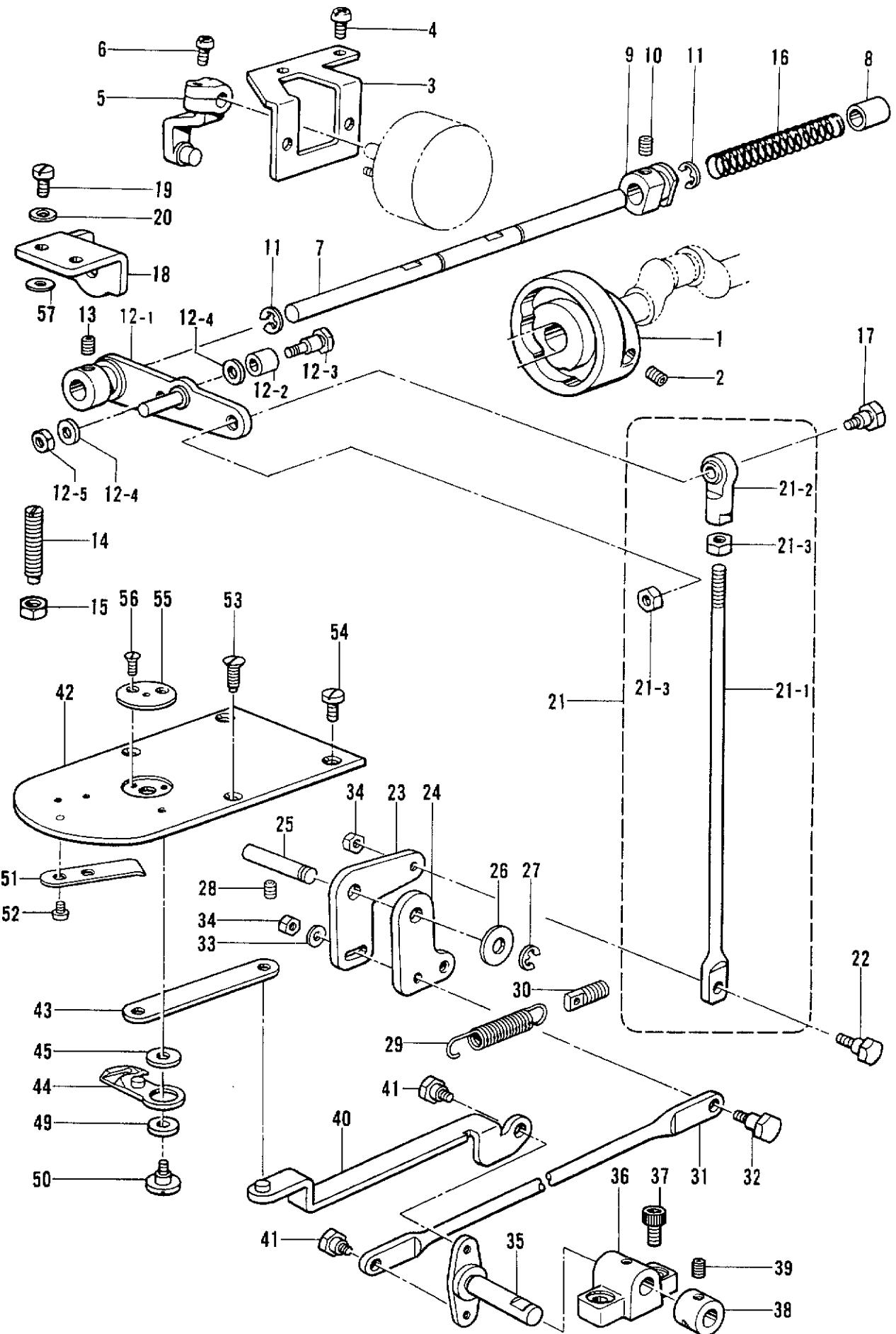
L. 糸切り関係/Thread trimmer mechanism/Fadenabschneidevorrichtung/
