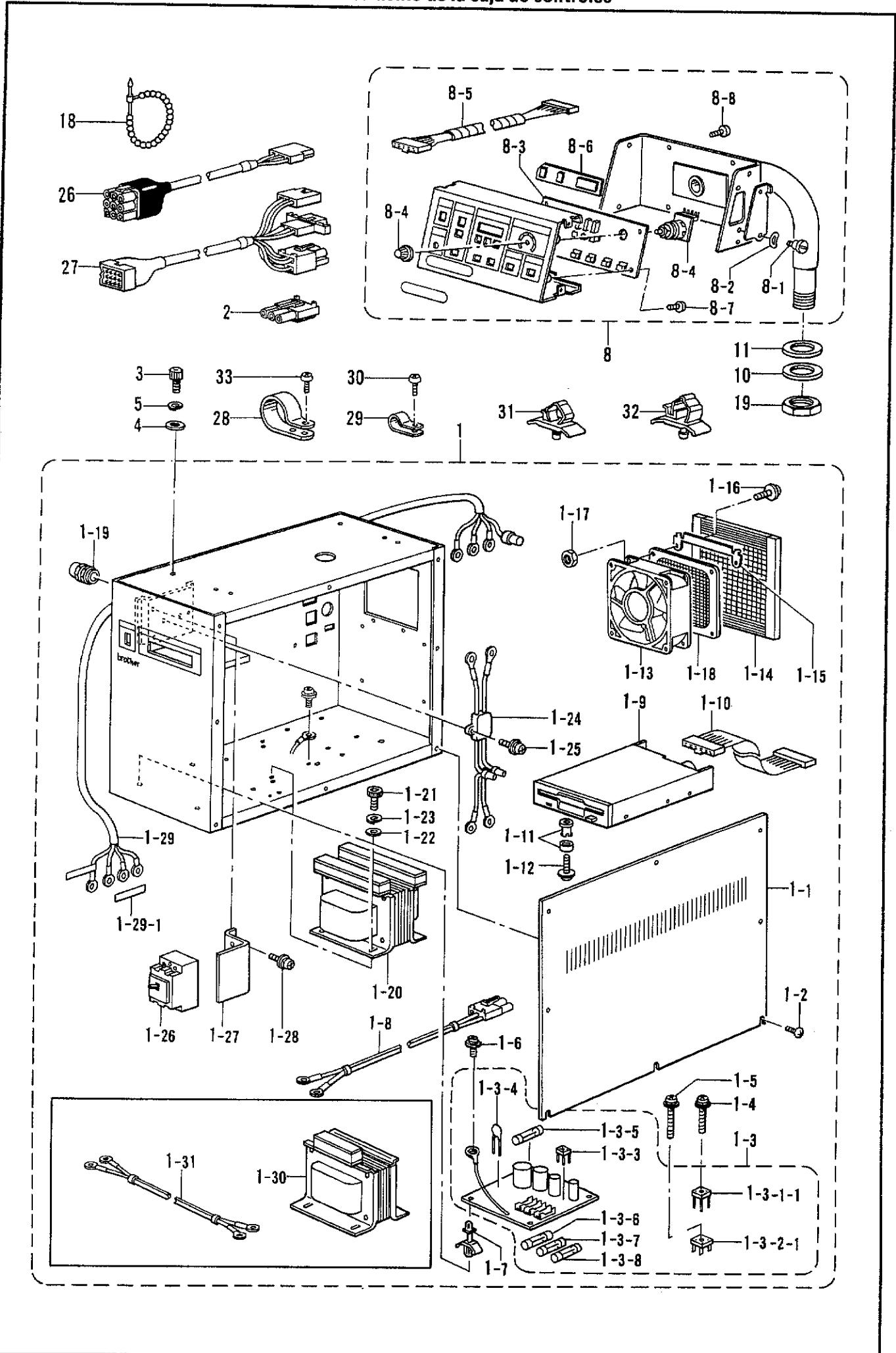
「. コントロールボックス関係 /Control box mechanism/Schaltkasten/
