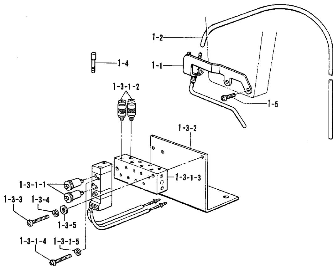
Y. 針冷却装置 /Needle cooler/Nadelkühlungsvorrichtung/
