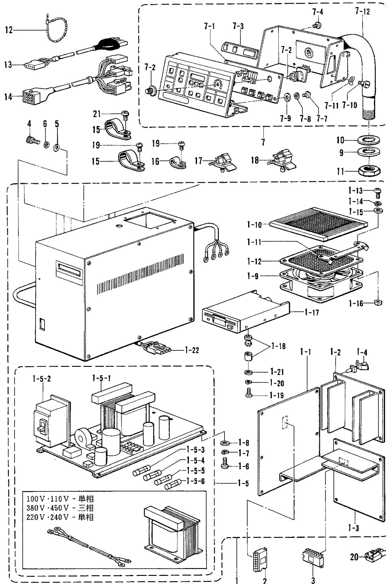
T. コントロールボックス関係/Control box mechanism/Schaltkasten/
