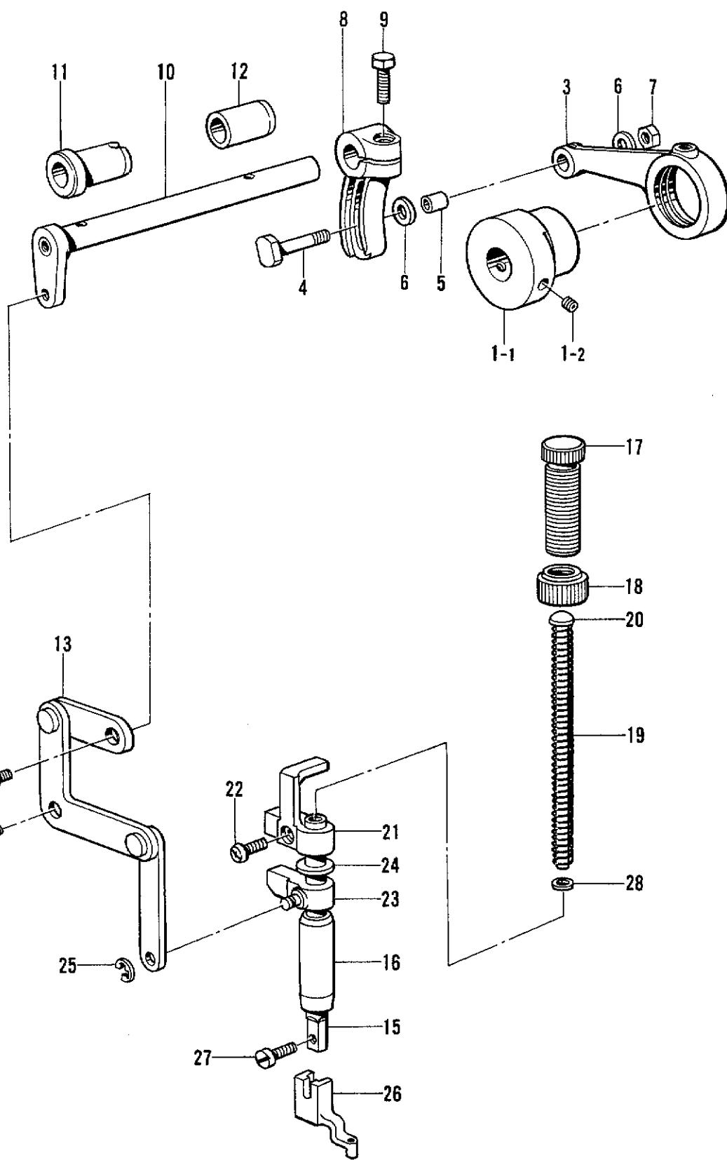
E. 押工上げ関係 /Work Clamp Lifter mechanism/Stoffhalterhebervorrichtung/
