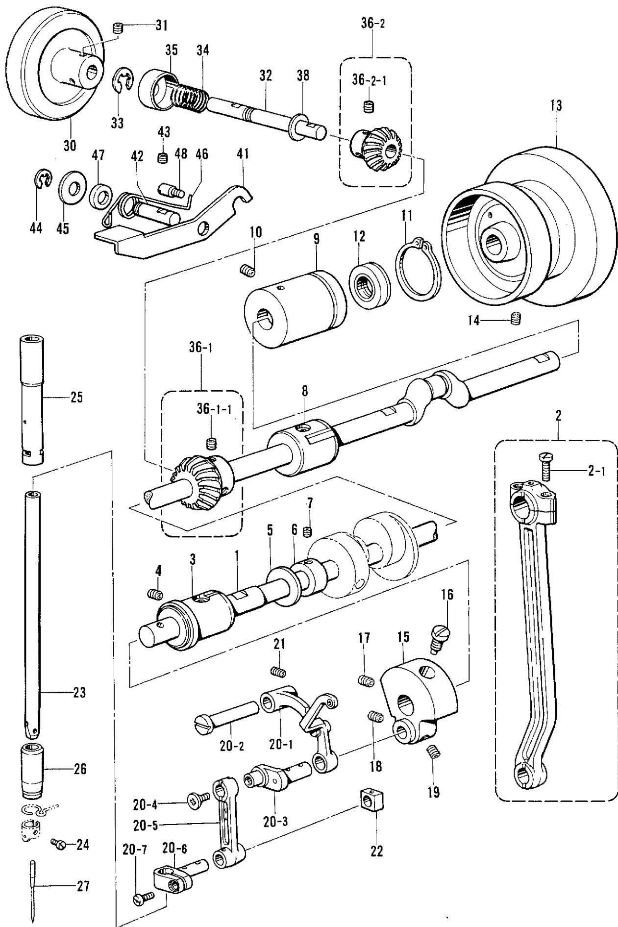
C. 上軸関係 /Upper shaft and needle bar mechanism/Obere Welle und Nadelstangenvorrichtung/
