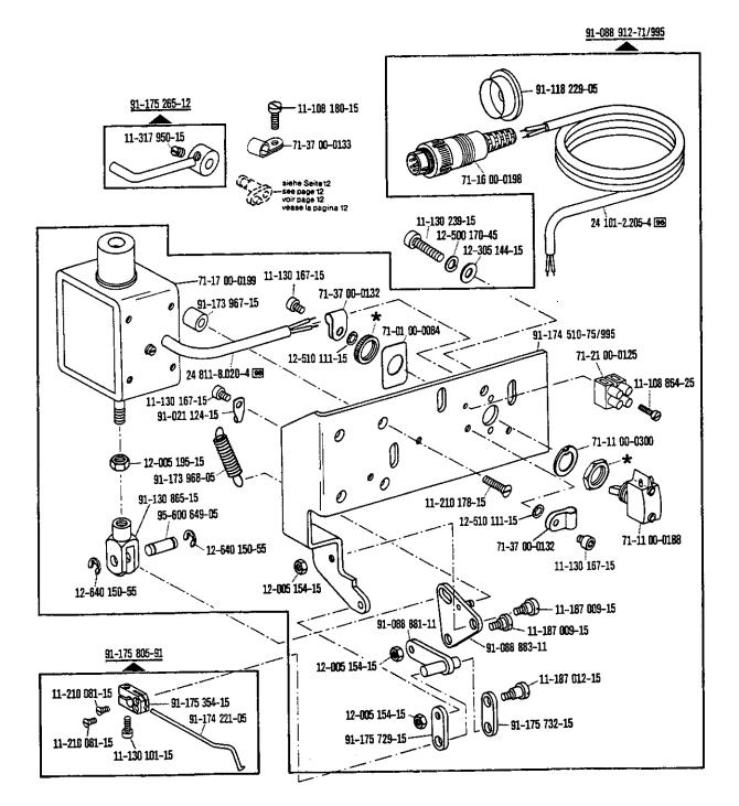
siehe Erläuterungen Register 0 see explanations in section 0 voir légende registre 0 ver explicaciones del registro 0 Presserfuß-Automatik Automatic presser foot lifter Releve-pied automatique Alzaprensatelas
