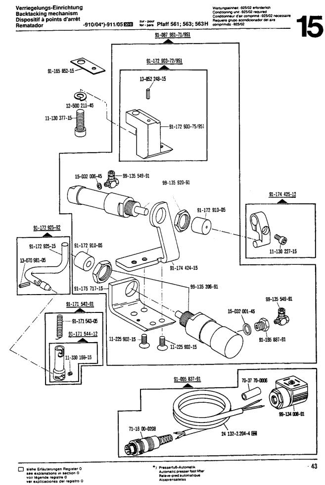
Automatic presser foot lifter Reléve-pied automatique Alzaprensatelas
