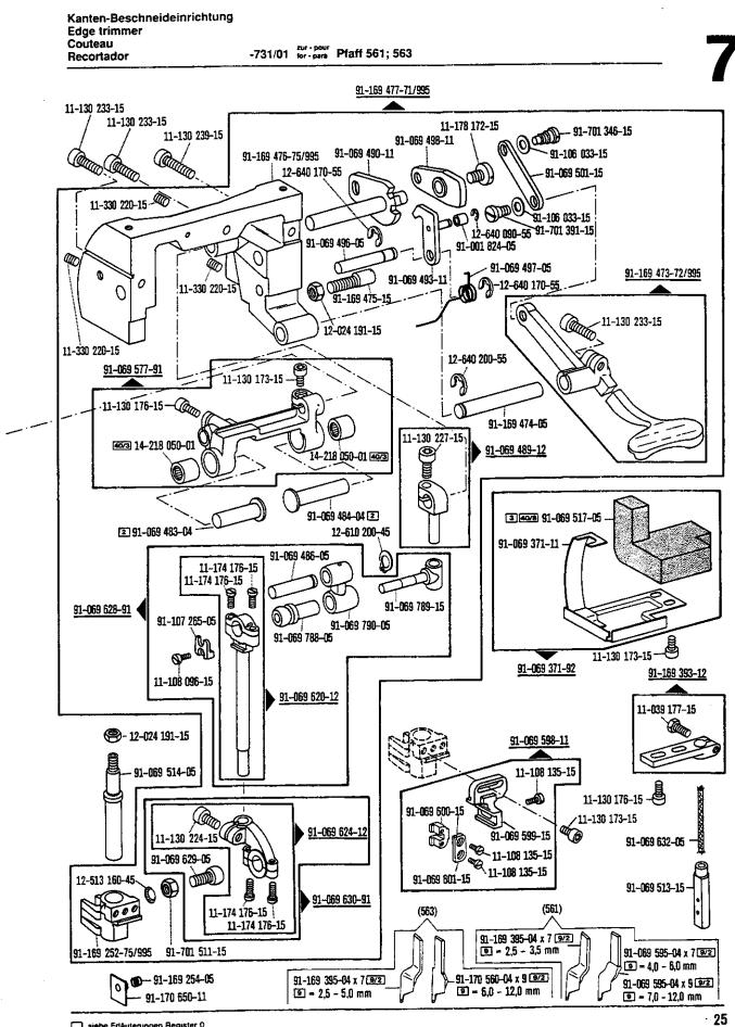
see explanations in section 0 voir légende registre 0 ver explicaciones del registro 0 Fadenabschneid-Einrichtung Thread trimmer Coupe-fil
