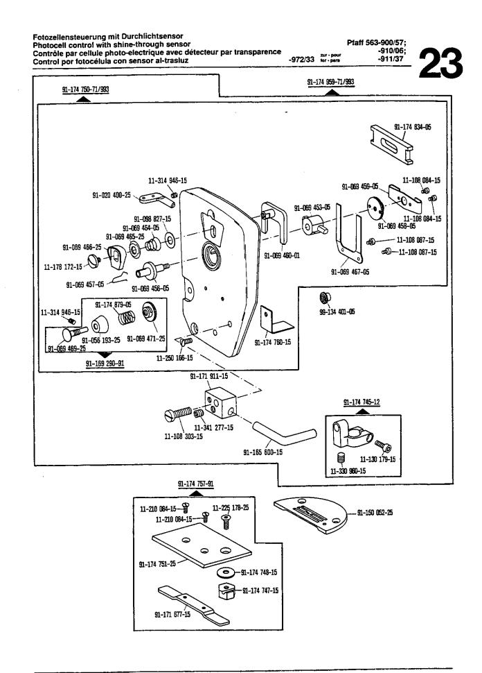
Fotozellensteuerung mit Durchlichtsensor Photocell control with shine-through sensor Contrôle par cellule photo-electrique avec détecteur par transparence Control por fotocélula con sensor al-trasluz -972/33 er - para -911/37
