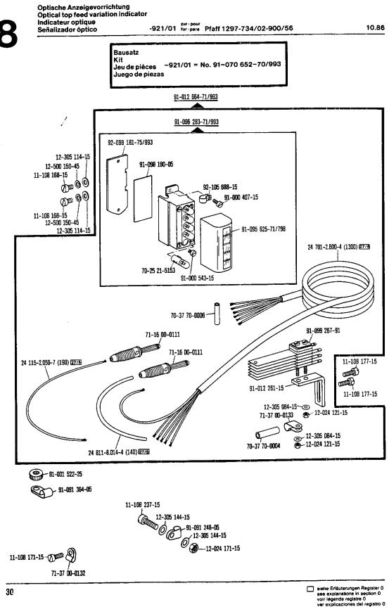
Optische Anzeigevorrichtung Optical top feed variation indicator Indicateur optique Señalizador óptico -921
