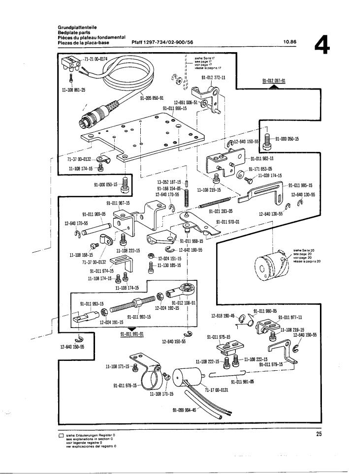
Gehäuseteile Housing sections Parties du corps Pfaff 1297-734/02-900/56 Piezas del cárter
