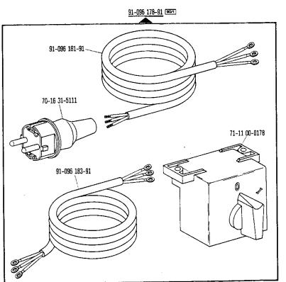
(Ausrüstung mit Motordrehschalter) (equipment with motor turn switch) Motoranschlußsatz Motor connection kit Jeu de pièces à raccorder le moteur Juego de piezas de conexión del motor (avec interrupteur rotatif) (con interruptor giratorio) tor-para Pfaff 1291
